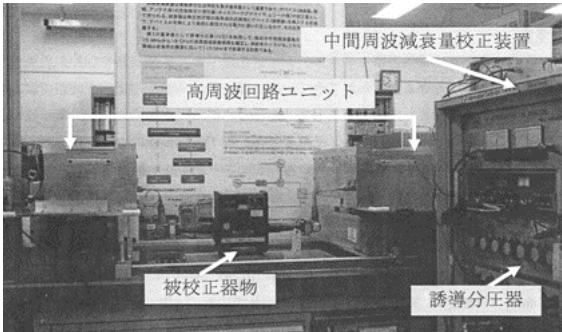
写真1 高周波減衰量測定装置 高周波減衰量測定装置は「中間周波置換法」を利用し、被校正器物の高周波減衰量を1kHz等の中間周波数の減衰量
